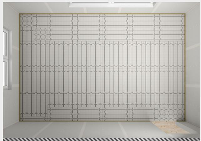
Esquema de instalación de dos circuitos de calefacción
