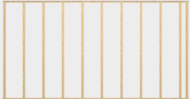
Distancia entre subestructura máximo 500mm
