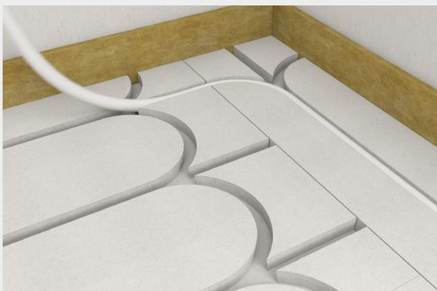
Colocación de las tuberías de 16mm. El ranurado especial no requiere de una fijación adicional de la tubería. Con recortes individualizados de los elementos Therm25™ se pueden conformar situaciones de paso de tubería de todo tipo, prescindiendo incluso de los elementos redondos Therm25™.
