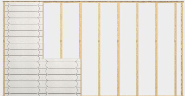
Montaje de los elementos Therm25™ a la subestructura (tornillos de 40 mm o grapas de 50 mm)
