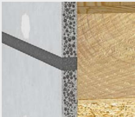
Imagen 4: Sellado de la junta con cordón de sellado precomprimido (ver detalle A)
