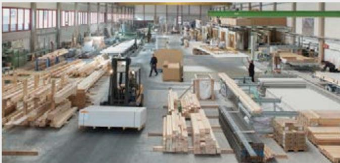
Fabricación de elementos de madera con paneles de fibra yeso fermacell
