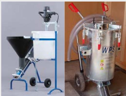
Bomba de mortero para la aplicación bajo el testero inferior
