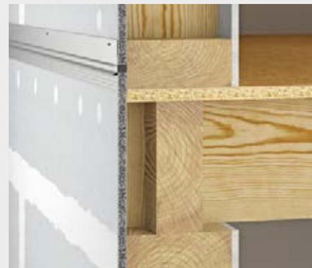
Imagen 6: Inserción de la pieza inferior del perfil de remate respetando la distancia al perfil superior prevista (equivalde al ancho de juntas). La fijación de la pieza inferior se realiza únicamente mediante el mortero ligero **fermacell** HD. La pieza superior se trata con el pegamento para sellado de juntas **fermacell** HD como puente de unión para el mortero ligero **fermacell** HD.
