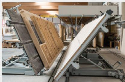
Mesa de trabajo que permite el vuelco del elemento constructivo
