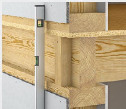
Imagen 1: Aplomado y alineación de los elementos de muro
