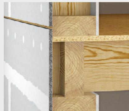
Imagen 3: Tratamiento de juntas HD (ver detalle B) en junta y fijaciones
