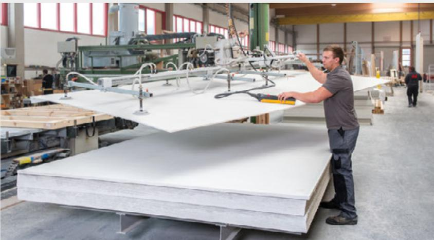
Transporte de paneles de fibra yeso fermacell® mediante máquina elevadora con ventosas
