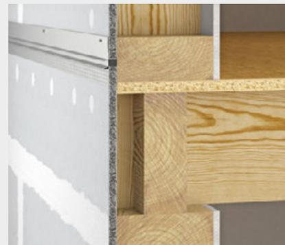
Imagen 6: Inserción de la pieza inferior del perfil de remate respetando la distancia al perfil superior prevista (equivala al ancho de juntas). La fijación de la pieza inferior se realiza únicamente mediante el mortero ligero fermacell™ HD. La pieza superior se trata con el pegamento para sellado de juntas fermacell™ HD como puente de unión para el mortero ligero fermacell™ HD.
