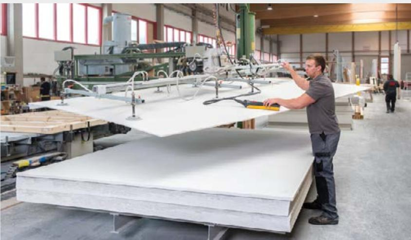
Transporte de paneles de fibra yeso fermacell® mediante maquina elevadora con ventosas
