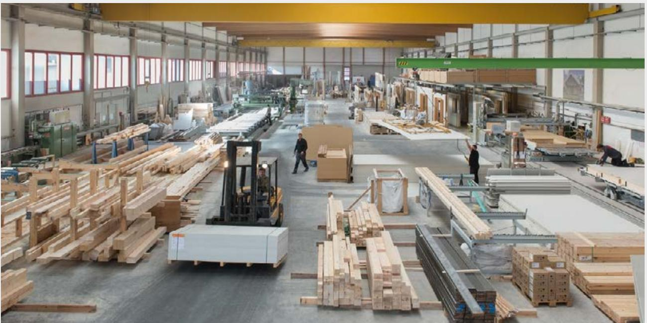
Prefabricación de elementos de madera con paneles de fibra yeso fermacell®
