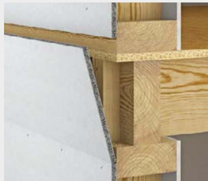
Imagen 2: Montaje de la tira de paneles (sin fijación a testero superior), dejando junta superior.
