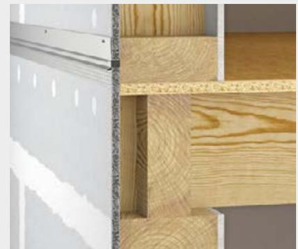
Imagen 6: Inserción de la pieza inferior del perfil de remate respetando la distancia al perfil superior prevista (equivalente al ancho de juntas). La fijación de la pieza inferior se realiza únicamente mediante el mortero ligero fermacell™ HD. La pieza superior se trata con el pegamento para sellado de juntas fermacell™ HD como puente de unión para el mortero ligero fermacell™ HD.
