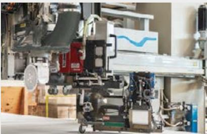
Imagen 2: Puente para la fijación automatizada mediante grapas
