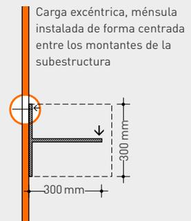
Cargas excéntricas (excentricidad 30 cm) ligeras y medianas en paneles de fibra yeso fermacell®
